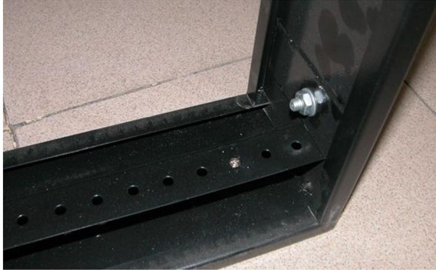
(2) 把电源没有接线柱的一侧（开有 U 型槽），固定在这个螺丝上。电源网面一侧保证与固定边条的边平行，然后再有接线柱一侧打孔固定另一个螺丝，如下图所示：
